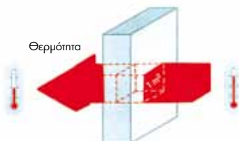
Ορισμός συντελεστή θερμοπερατότητας ενός δομικού στοιχείου
